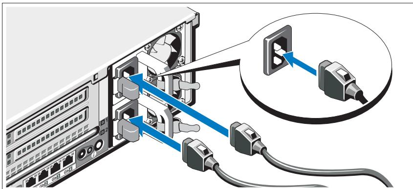
Conecte o(s) cabo(s) de alimentação ao sistema e, se for usado um monitor, conecte o(s) cabo(s) de alimentação ao monitor.
