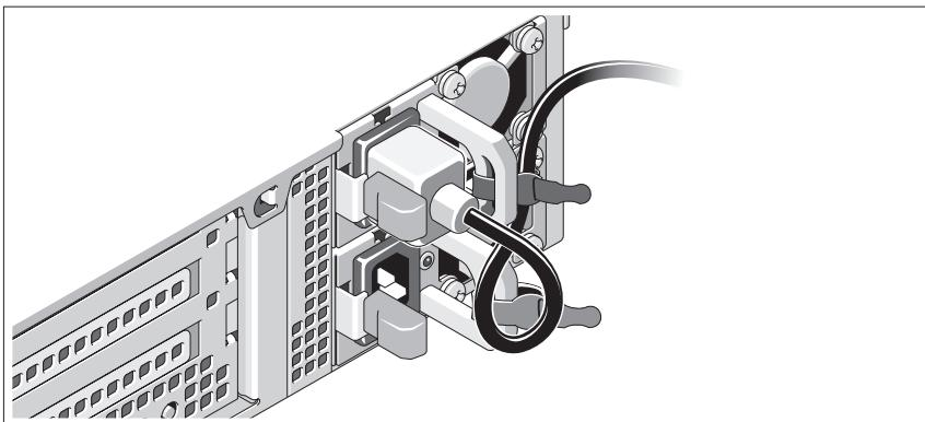
Faites une boucle comme indiqué dans l'illustration, puis fixez-le à l'aide de la sangle fournie. Branchez ensuite l'autre extrémité du câble d'alimentation sur une prise secteur mise à la terre ou sur une source d'alimentation autonome (onduleur ou unité de distribution de l'alimentation).
