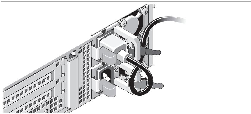
Doble el cable de alimentación del sistema en forma de bucle, como se muestra en la ilustración, y fíjelo al soporte con la correa proporcionada. Conecte el otro extremo del cable de alimentación a una toma eléctrica con conexión a tierra o a otra fuente de energía, como por ejemplo un sistema de alimentación ininterrumpida (SAI) o una unidad de distribución de alimentación (PDU).
